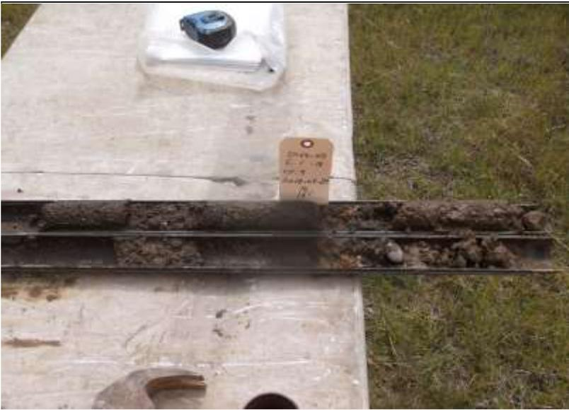
PHOTO #3: Stratigraphie présente de 2,25 m à 6,65 m constituée de sable et gravier brun comportant des traces de silt. Présence d'eau à 4,50 m
