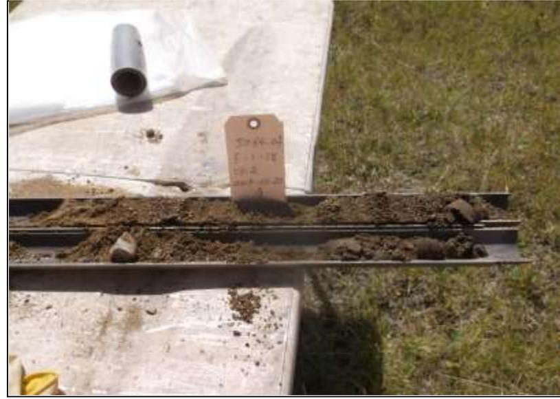
PHOTO #2: Stratigraphie présente de 0,15 m à 2,25 m constituée de sable brun comportant des traces de silt et de gravier.
