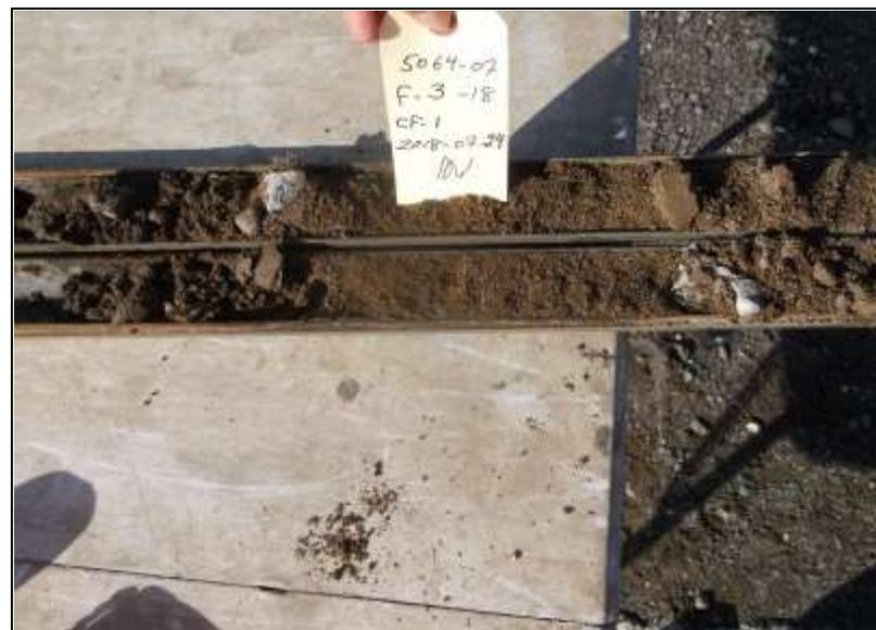
PHOTO #8: Stratigraphie présente de 0,10 m à 0,75 m constituée d'un remblai sable brun comportant des traces de silt et de gravier.
