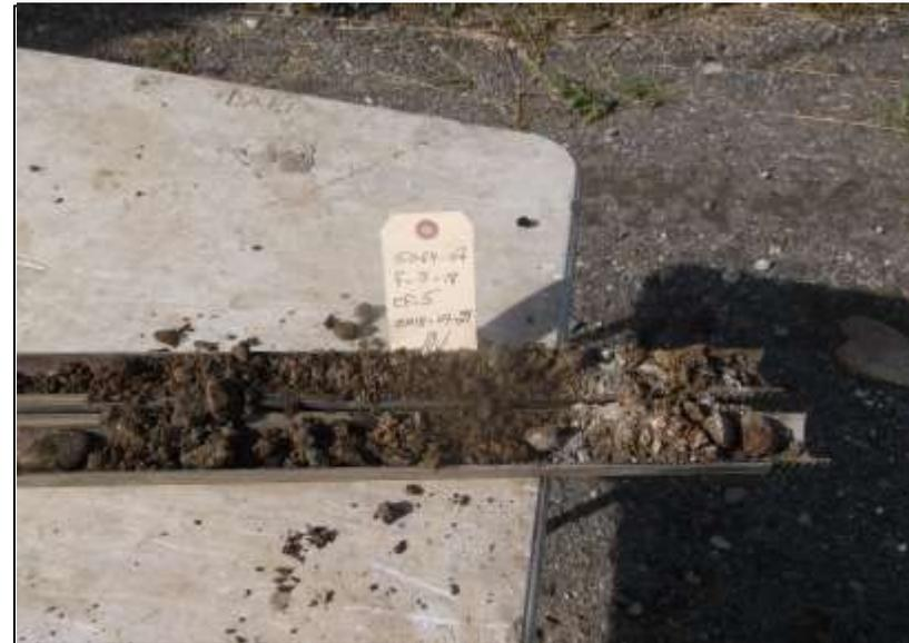
PHOTO #10: Stratigraphie présente de 3,00 m à 4,50 m constituée de sable et gravier brun comportant des traces de silt.
