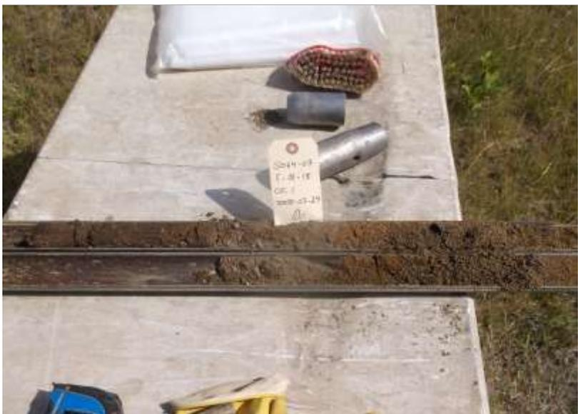
PHOTO #5: Stratigraphie présente de 0,20 m à 1,50 m constituée de sable brun comportant des traces de silt et de gravier.
